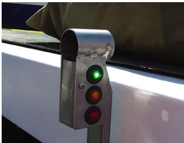
Figura 16 - Leitor RFID instalado em esteiras da Delta Airlines.
