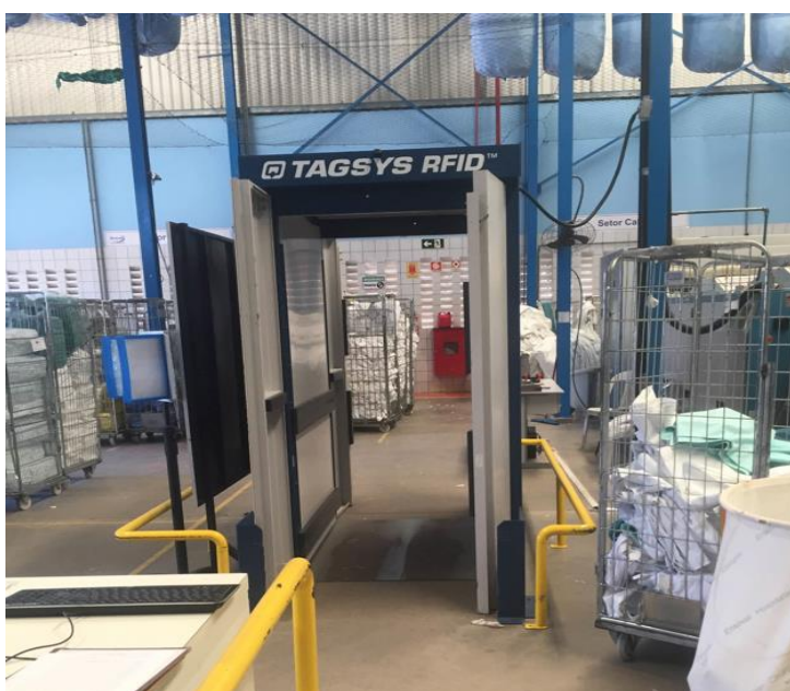
Figura 32 – Cabine leitora RFID
