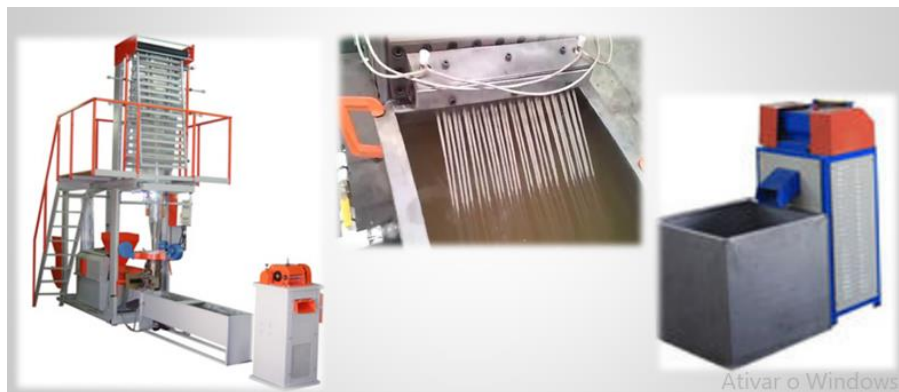
Figura 08 – Extrusora de recuperação termoplástica produzindo grãos
